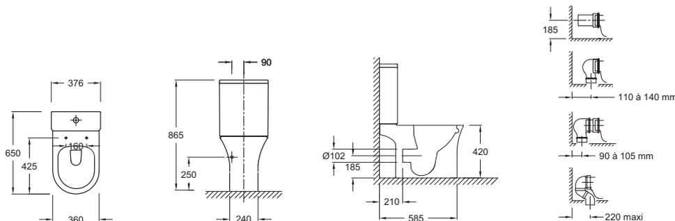
Спецификация продукта : Бачок 3/6 л, нижний подвод воды. ETAL212. Коллекция : ALEO. РАЗМЕРЫ (CM) : 37.80 x 13.50 см. ВЕС : 13.2 кг. МАТЕРИАЛ : Огнеупорная керамика. NOUVEAUTÉ : 0.
